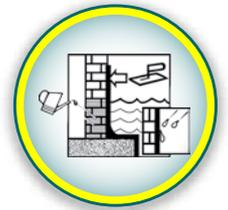
**Enduit de recouvrement de microfissures à 2 composants, pour travaux alternatifs d'étanchéité en épaisseur de couche de 1,5 à 5 mm.**
